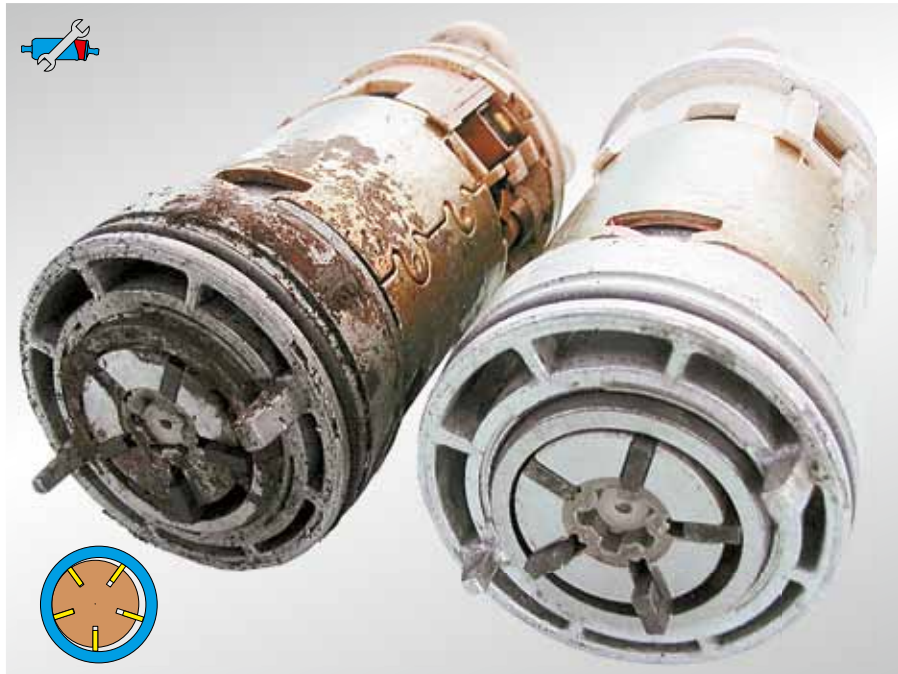
Rys. 36: Uszkodzenia pompy łopatkowej spowodowane obecnością wody Dla porównania: z prawej strony pompa paliwowa o porównywalnym przebiegu, nie narażona na działanie wody.
