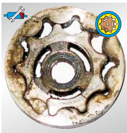
Rys. 19: Zablokowany zespół tłoczenia (pierścień zębaty trochoidalny) pompy z pierścieniem zębatym E3T
