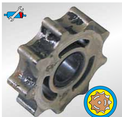
Rys. 32: Masa uszczelniająca w zespole tłoczenia (trochoidalne koło zębate)
