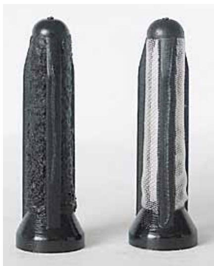
Rys. 22: Filtr sitkowy pompy łopatkowej E1; Fz lewej strony zapchany – z prawej strony nowy
