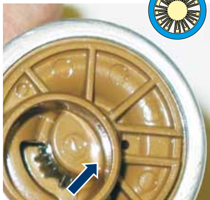
Rys. 34: Żebra wirnika pompy typu E1S z kanałami bocznymi zostały uszkodzone przez ciało obce (z lewej strony). Odłamki znajdujące się w filtrze (z prawej strony).
