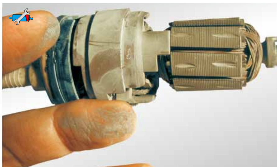
Rys. 56: Osad spowodowany niską jakością paliwa
