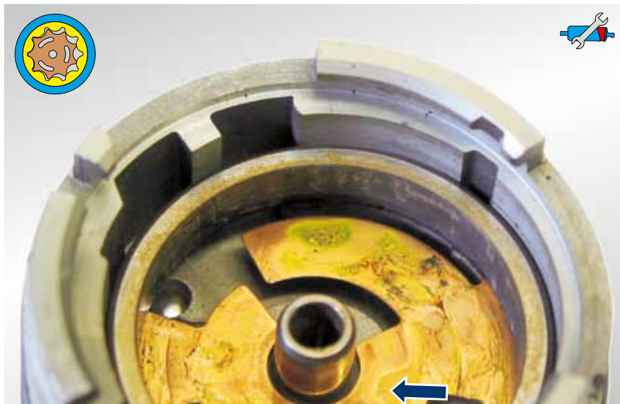
Rys. 59: Zaklejony zespół tłoczenia Wirnik był mocno sklejony z trochoidalnym zespołem tłoczenia. W celu wykonania zdjęcia wyjęto zespół tłoczenia – jego obrys jest jeszcze dobrze widoczny w kleistej masie.
