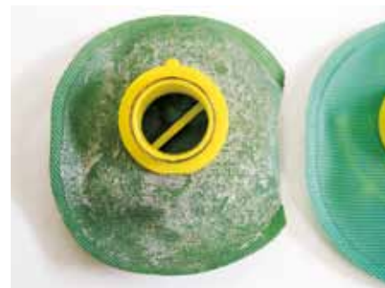
Rys. 42: Z lewej strony: osady wapnia w filtrze pompy zbiornikowej; z prawej strony: dla porównania nowy filtr
