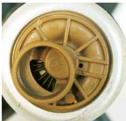
Rys. 34: Żebra wirnika pompy typu E1S z kanałami bocznymi zostały uszkodzone przez ciało obce (z lewej strony). Odłamki znajdujące się w filtrze (z prawej strony).
