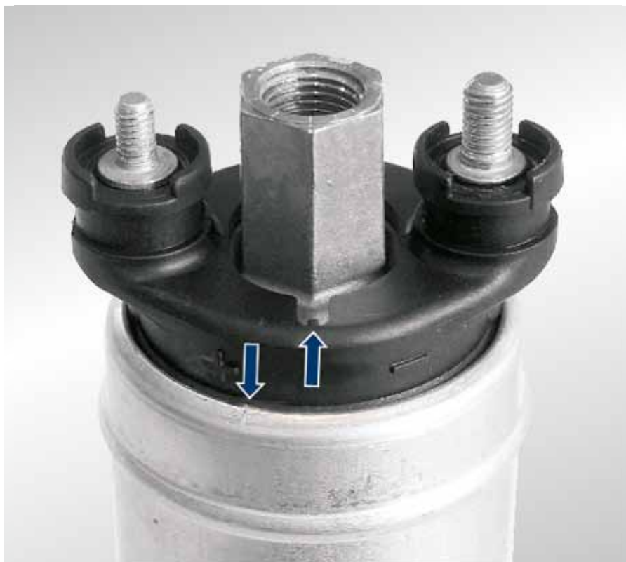
Rys. 69: Obrócona pokrywa pompy Na pompach paliwowych typu E2T i E3T są umieszczone oznaczenia. Muszą się one znajdować naprzeciw siebie. Jeżeli tak nie jest oznacza to, że pompa była niewłaściwie montowana i tym samym została uszkodzona.
