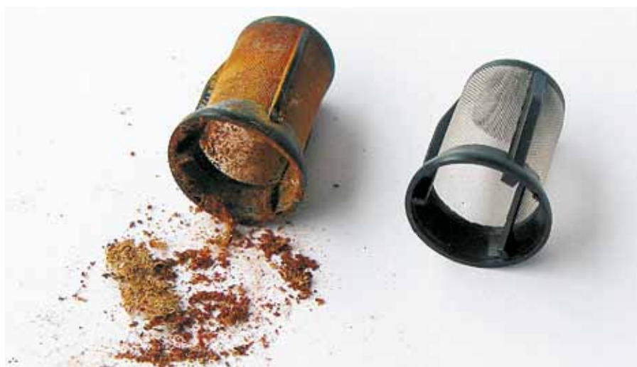
Rys. 41: Z lewej strony: filtr sitkowy zapchany rdzą; z prawej strony: nowy filtr sitkowy
