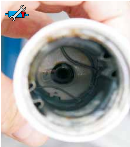
Rys. 44: Woda w pompie paliwowej
