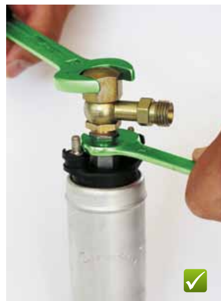
Rys. 71: Prawidłowy montaż: należy przytrzymać kluczem dolny sześciokąt pompy paliwowej
