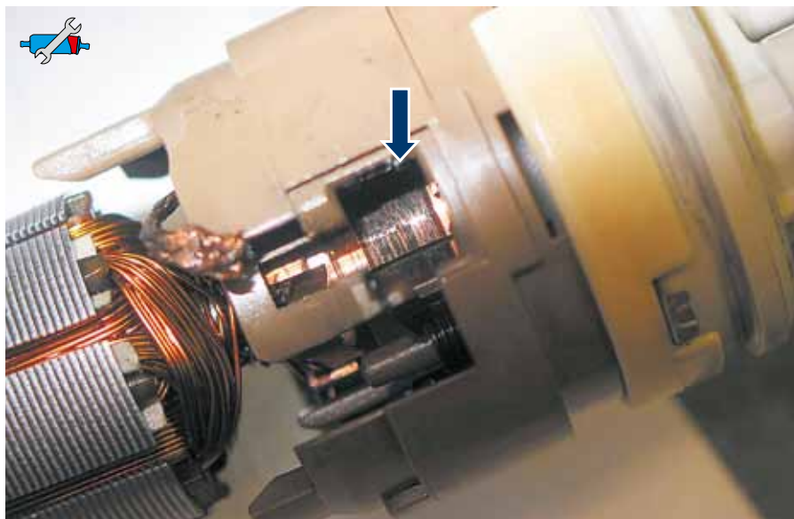
Rys. 61: Widok na uchwyty styków ślizgowych. Szczotki węglowe zostały całkowicie rozpuszczone i utworzyły powłokę na komutatorze.
