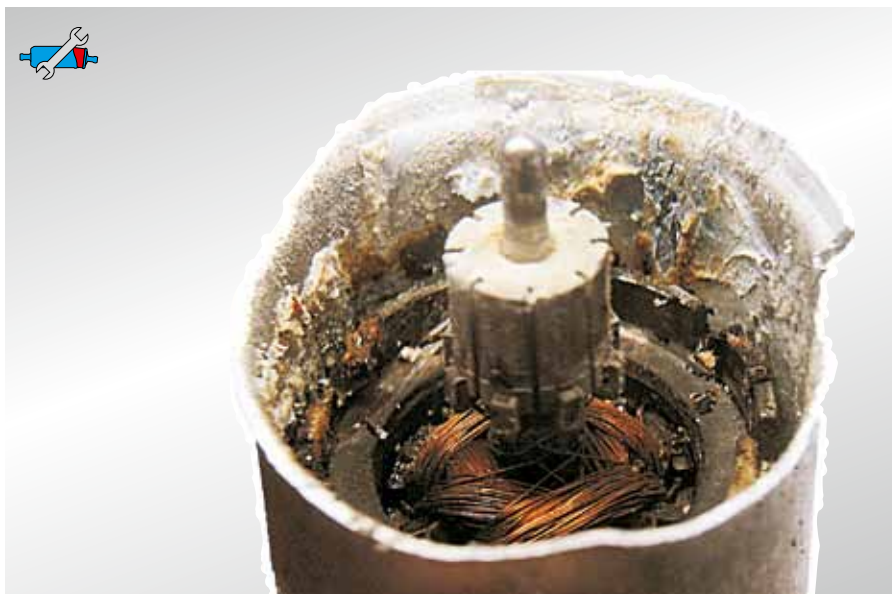
Rys. 16: Silnie skorodowana elektryczna pompa paliwowa. Widok, którego z reguły nie zobaczy się w warsztacie. W wielu przypadkach przyczynę awarii pompy paliwowej, która od zewnątrz wygląda na sprawną, można ustalić dopiero po rozmontowaniu pompy.
