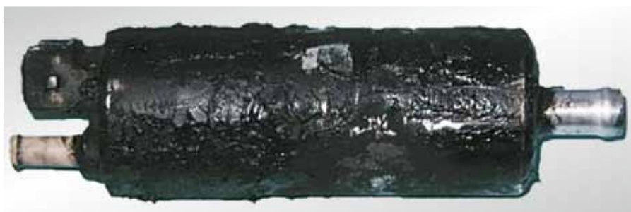
Rys. 65: Pompa przewodowa zastosowana jako pompa zbiornikowa
