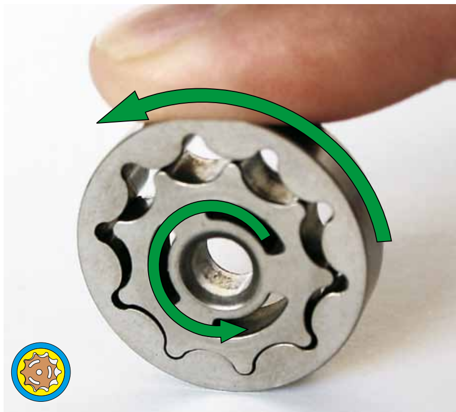
Rys. 52: Trochoidalny zespół tłoczenia musi się obtaczać z małymi oporami ruchu
