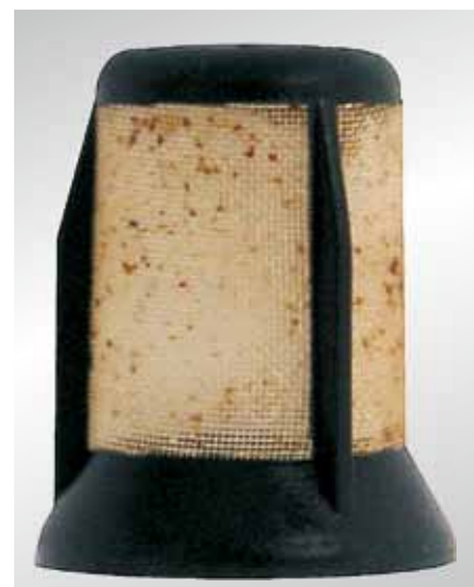
Rys. 23: Zanieczyszczony filtr sitkowy pompy z pierścieniem zębatym E3T
