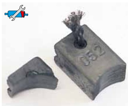
Rys. 62: Styki ślizgowe po ok. 15.000 km. Z lewej: przedwcześnie zużyte; z prawej: stan normalny po takim przebiegu
