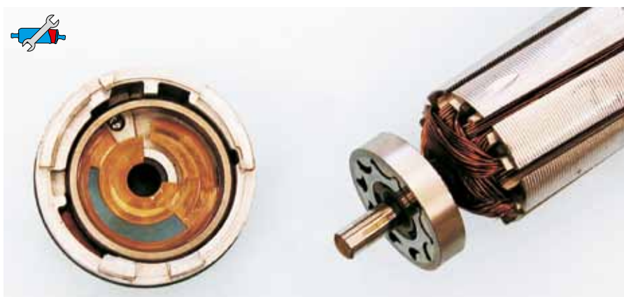
Rys. 38: Dla porównania: pompa z pierścieniem zębatym E3T w dobrym stanie mimo dużego przebiegu
