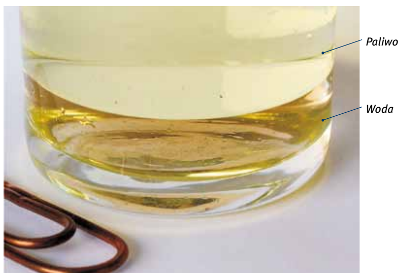
Rys. 39: Woda w paliwie
