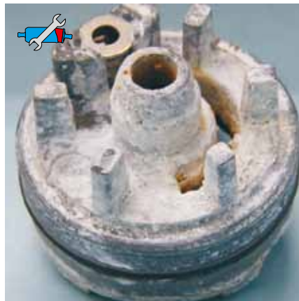
Rys. 50: Łożysko zewnętrzne pompy paliwowej pokryte osadami wapnia
