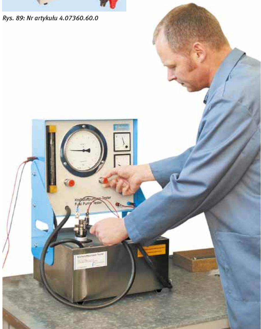
Rys. 90: Zastosowanie testera pomp paliwowych 4.07370.60.0
