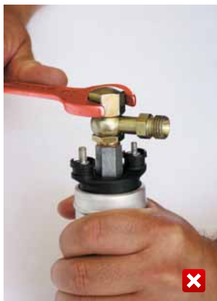
Rys. 70: Nieprawidłowy montaż: dokręcanie bez przytrzymania
