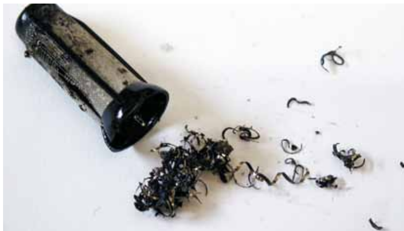
Rys. 29: Wióry w filtrze sitkowym W tym przypadku metalowe wióry przedostały się do zbiornika paliwa podczas wykonywania prac w układzie paliwowym. Wióry o ostrych krawędziach uszkodziły filtr sitkowy. Wskutek tego zanieczyszczenia przedostały się do pompy i zablokowały zespół tłoczenia.
