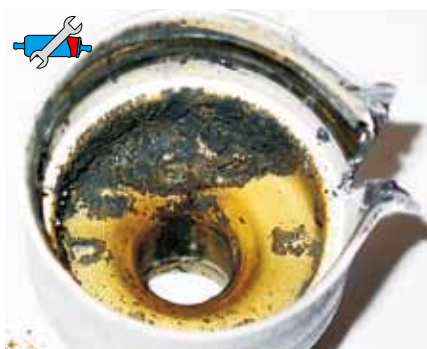
Rys. 18: Widok na rozciętą obudowę pompy z pierścieniem zębatym E3T – zapchaną osadami
