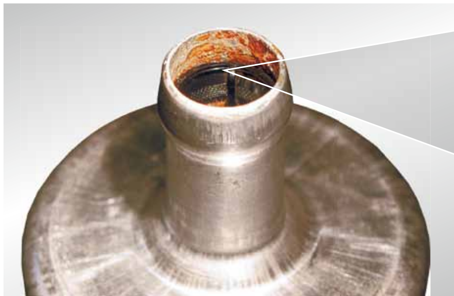
Rys. 40: Skorodowany wlot do pompy łopatkowej E1F
