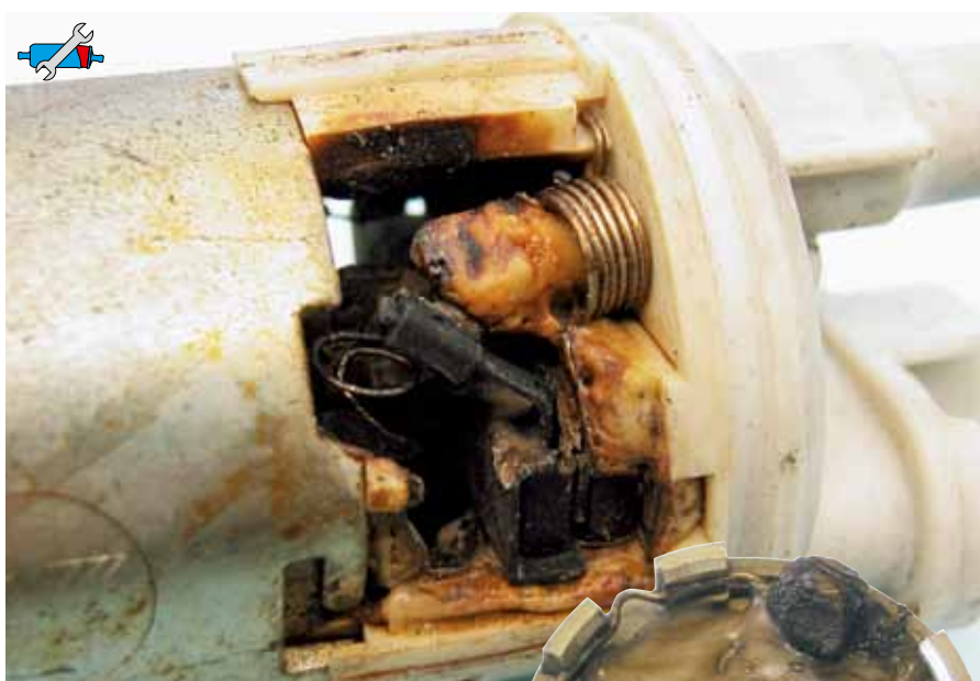
Rys. 20: Zatarcia spowodowane pracą na sucho
