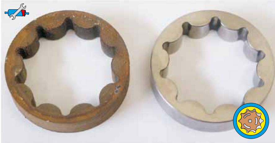
Rys. 48: Z lewej strony: silnie skorodowany pierścień zębaty trochoidalny; z prawej strony: nowy pierścień
